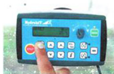
Na panelu obsługowym w kabinie można m.in. ustawić prędkość unoszenia i opuszczania tylnej zasuwy. Wartość odczytujemy na wyświetlaczu w formie procentowej.
