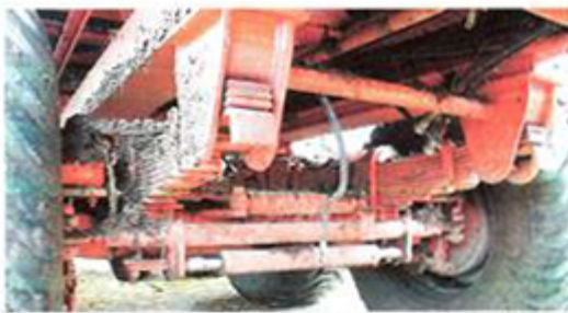
Osie maszyny zawieszono na piórowych resorach parabolicznych. Pierwsza i ostatnia oś jest konstrukcją nadążną, o czym świadczy obecność silownika blokady skrętu.
